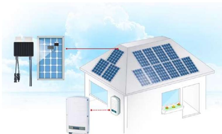
Les optimiseurs sont des dispositifs utilisés dans les installations photovoltaïques **pour minimiser les pertes** (en cas de différence entre les panneaux, d'ombrage (attention à la durée de vie) ou de différence d'orientation par rapport au soleil).
