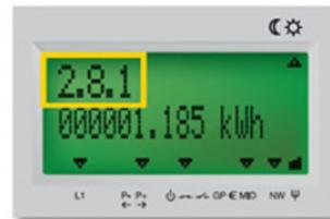
> **2.8.1** - Total des kWh d'énergie injectée aux heures pleines.
