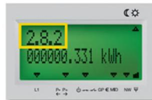
> **2.8.2** - Total des kWh d'énergie injectée aux heures creuses.
